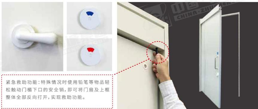
紧急救助功能:特殊情况时使用铅笔等物品轻松触动门楣下口的安全销,即可将门扇及上框整体全部反向打开,实现救助功能。
